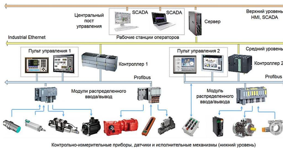
Рис. 2. Уровни АСУ ТП Fig. 2. Automated control system levels
