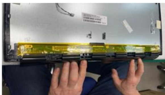
Рис. 5. Нанесение термоскотча на печатную плату
