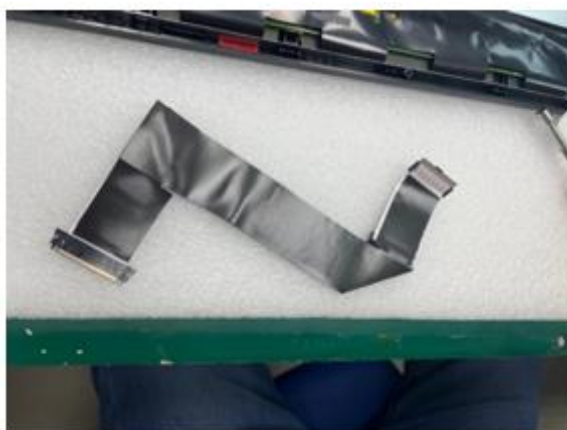
Рис. 3. Оклейка шины LVDS мягким железом
