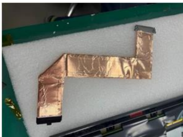
Рис. 4. Оклейка шины LVDS медной лентой
