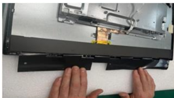
Рис. 6. Оклейка печатной платы радиопоглощающим материалом FАM
