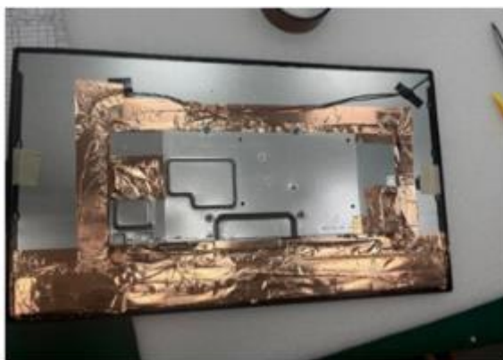
Рис. 7. Оклейка медной лентой всевозможных мест передачи LVDS сигнала
