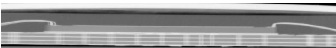
Рис. 12. Рентгеновская фотография среза СБИС
