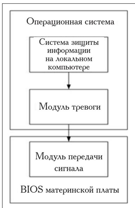
Рис. 1. Принципиальная схема измененной системы защиты
