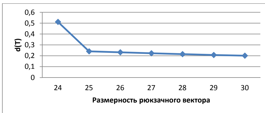
Рис. 1. Зависимость неравномерности вычислительной нагрузки d(T) от размерности рюкзачного вектора при фиксированном числе доступных процессоров ( p = 50 )
